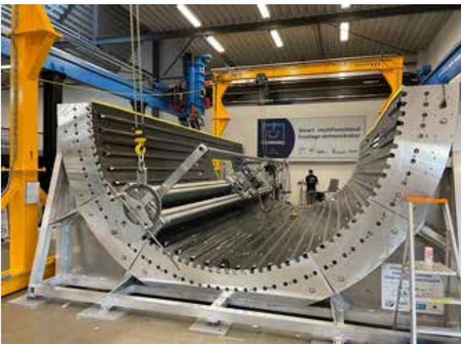
Fuselage carbone où la technologie de soudage par ultrason a été en partie validée chez Rescoll, entreprise associée au projet MECASTERS
